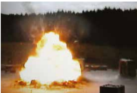
Trykket fra eksplosionen påvirker dørene under testen
